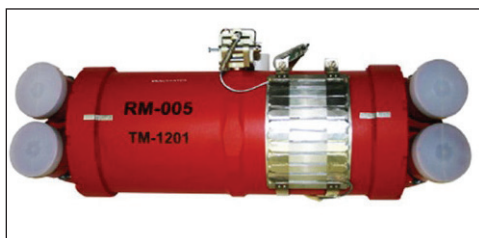
Sl. 4. Raketni uređaj URM-1 za katapultiranje VS-1 BRI kod aviona L-39 Albatros. Proizvodnja Aerospace and Defence Products AD Mojkovac Izvor: https://oruzjeonline.com/2021/09/17/pistolj-9-mm-tara-tm-9-i-jurisne-puske-tara/
